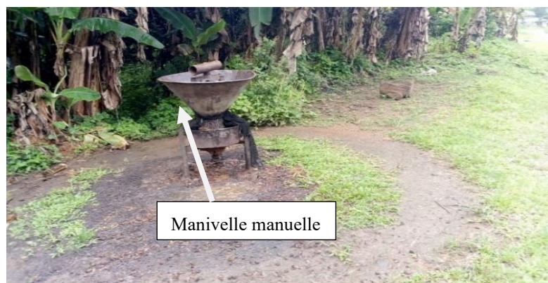
Photo 1. Installation d'une usine manuelle d'extraction d'huile de palme à Solopa et Ndjok Loumbé
