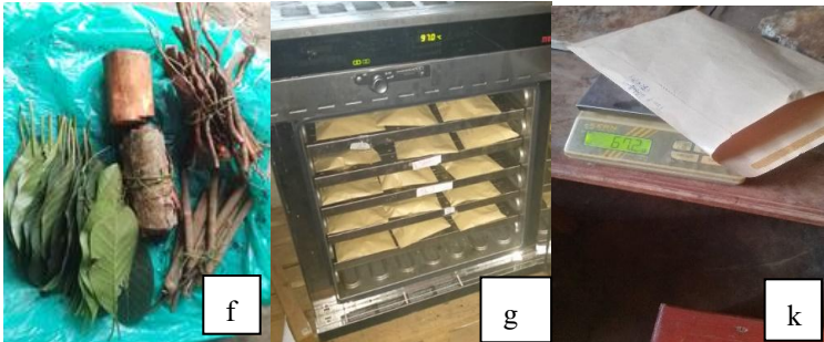
Figure 4. Empilage des échantillons frais (f), Pesage de l’échantillon, Etuve(g) et Pesage des échantillons séchés au labo (k)/Stacking of fresh samples (f), Weighing of samples Oven (g) and Weighing of dried samples in the lab (k).
